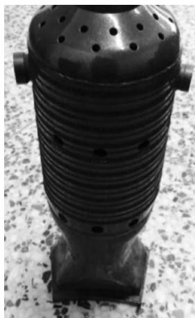
图 6 火焰筒实物照片
